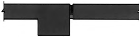
Junta de movimiento vertical en el lateral de una pilastra
