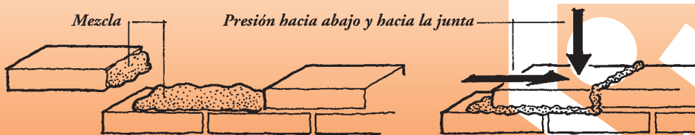
Colocación a restregón de ladrillos
