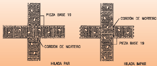
Detalle de cruce de muros de 19 cm
