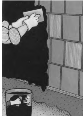
Aplicación del emplastecido
