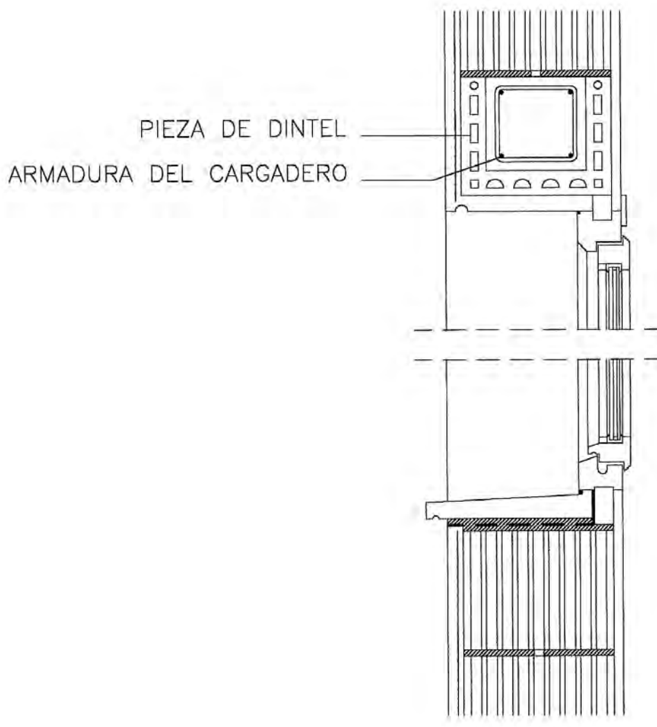
Armadura del cargadero para obtener suficiente rigidez
