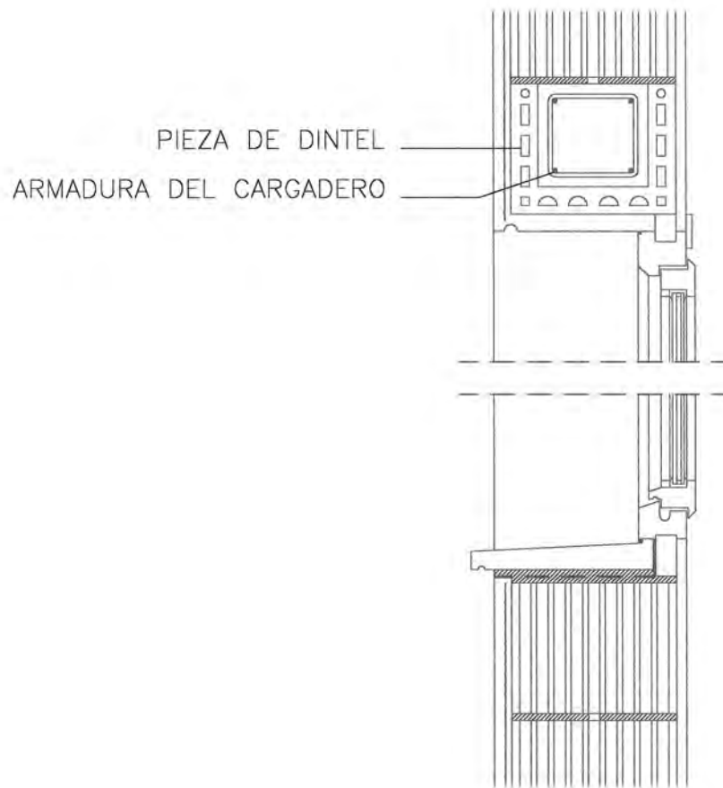
Cargadero con la pieza en U de Termoarcilla
