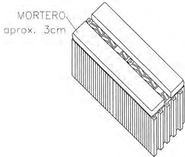
Tendel discontinuo en exterior
