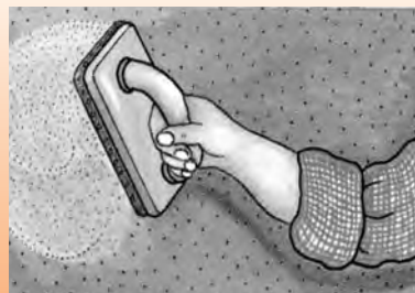
La superficie se alisa con la tabla con fieltro
