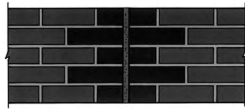
La situación de las juntas de movimiento puede hacerse aprovechando zonas en la fachada que disimulen o enfatizen su posición
