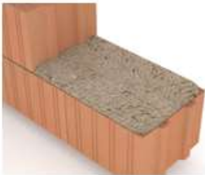
Montaje 1: Junta horizontal de mortero continua
