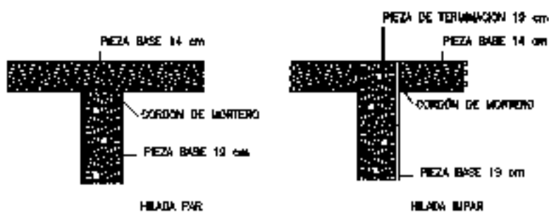
DETALLE DE ENCUENTRO EN T DE MURO DE 13 cm CON MURO DE 14 cm
