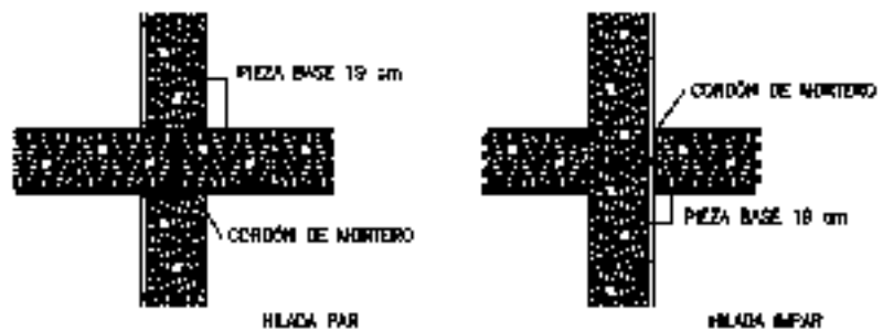
DETALLE DE CRUCE DE MUROS DE 18 cm
