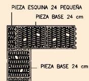
DETALLE DE ESQUINA DE MUROS DE 24 cm - CON PIEZAS ESPECIALES-
