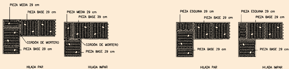
DETALLE DE ESQUINA DE MUROS DE 29 cm
